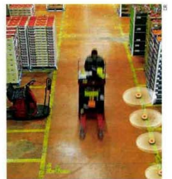
À l'entrée des travées, les tags diffusent les données sur la nature des marchandises.
